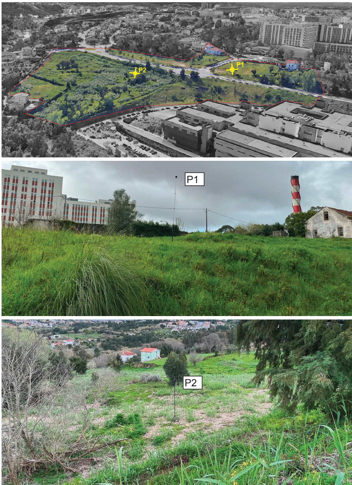
Figura 5 – Fotografia aérea com a marcação dos recetores (P1 e P2) e da localização dos microfones nos tripés (a cerca de 4 m de altura).
