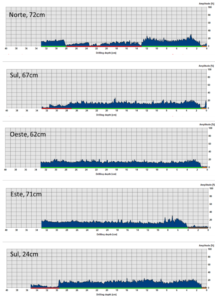
Figura 15. Resultados do Resistógrafo do exemplar #44 de Jacarandá. Os gráficos representam o perfil de resistência da madeira em quatro orientações (N, S, W, E) e a altura a que foram efetuados. A profundidade da perfuração foi até 33 cm, estimada a partir do cálculo do raio da árvore. O último gráfico mostra uma medição efetuada a 24 cm do solo, com um ângulo de 20°, sendo a profundidade de perfuração maior para compensar o ângulo. Código de cores: laranja – casca; verde - madeira sã; amarelo: - madeira com alguma degradação; vermelho - madeira degradada.
