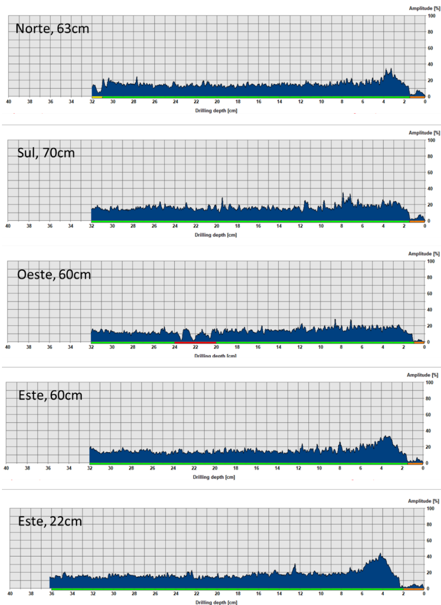
Figura 12. Resultados do Resistógrafo do exemplar #41 de Jacarandá. Os gráficos representam o perfil de resistência da madeira em quatro orientações (N, S, W, E) e a altura a que foram efetuados. A profundidade da perfuração foi até 32 cm, estimada a partir do cálculo do raio da árvore. O último gráfico mostra uma medição efetuada a 22 cm do solo, com um ângulo de 20°, sendo a profundidade de perfuração maior para compensar o ângulo. Código de cores: laranja – casca; verde - madeira sã; amarelo: - madeira com alguma degradação; vermelho - madeira degradada.
