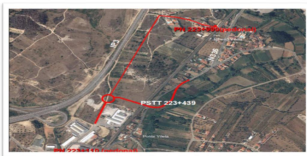
Figura 16 – solução apresentada para a supressão das PN 223+110 e 223+990
