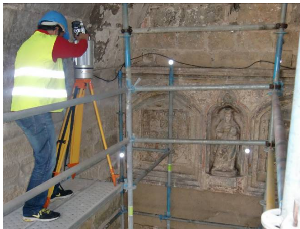
Trabalhos de levantamento por sistema de varrimento laser (ARTESCAN)
